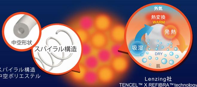
「スパイラル構造中空再生ポリエステル」と「リファイブラ™テクノロジーによって生み出されたテンセル™リヨセル繊維」を組み合わせる事により、繊維の隙間に空気層を作り、嵩高性、保温性を高めた環境配慮型の吸湿発熱綿。
